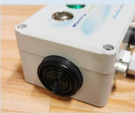
Doplňení o sirénu. Spustí na cca 1sec po dokončení odpočtu času, nebo dle přání lze naprogramovat na jiné časy a chvíle. Například u stopek na čas 15sec před dokončením odpočtu či ulity start při boulderingu. Piezosiréna na časomíře má hlasitost 120dB a nebo v ovládací krabičce 90dB/2.9kHz.
