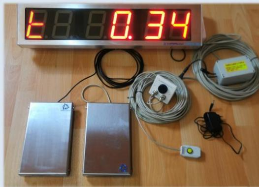
**Příklad** sestavy časomíry pro lezení na boulderingové stěně se zobrazením reakčního času, zvukovou signalizací startu a nášlapnými deskami. Délky kabelů si lze zvolit podle umístění na vaší stěně.
