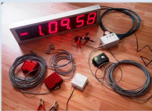
**Příklad** kompletní sestavy menší časomíry ALLinONE HL s 10cm číslicemi pro 4 dráhy v bezdrátovém provedení. V sestavě je akustický spínač a kabeláž na nástřikové terče. Napájecí adaptér 220v/12v a kabel napájení z autobaterie. SW pro zpracování výsledků v PC je zdarma.
