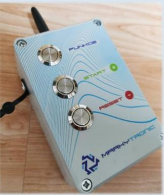
Příklady bezdrátových akustických spínačů, dle požadavku zákazníka, napájený z vaší externí baterie 12V, nebo Li-pol baterií uvnitř akustického spínače. Na spínači je START a RESET tlačítko. Lze použít pouze v některých sestavách časomír. (na dotaz) Součástí je nabíječka 12.6V/1A. Další možností je dálkové ovládání časomíry.
