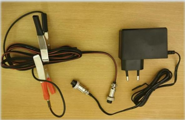
Napájecí adaptér 12V/1.5-2A a kabel napájení z autobaterie (sada).
