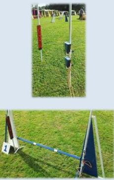
Optozávora s kabelem cca 7m bez stativů. Naproti senzoru je odrazko. Připojí se buď k časomíře, 100m kabelu od nástřikových terčů, nebo bezdrátovému modulu. Dosah max. 2 metry.
